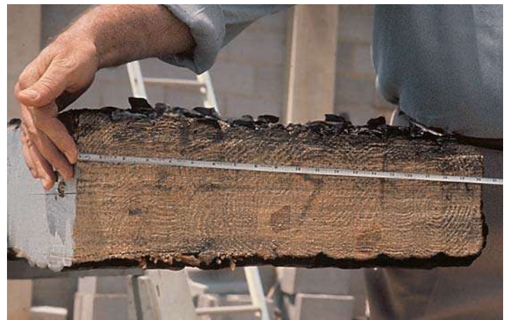
CENTRO: Viga laminada normal envuelta en llamas durante una prueba estándar de exposición al fuego ASTM E-119.
